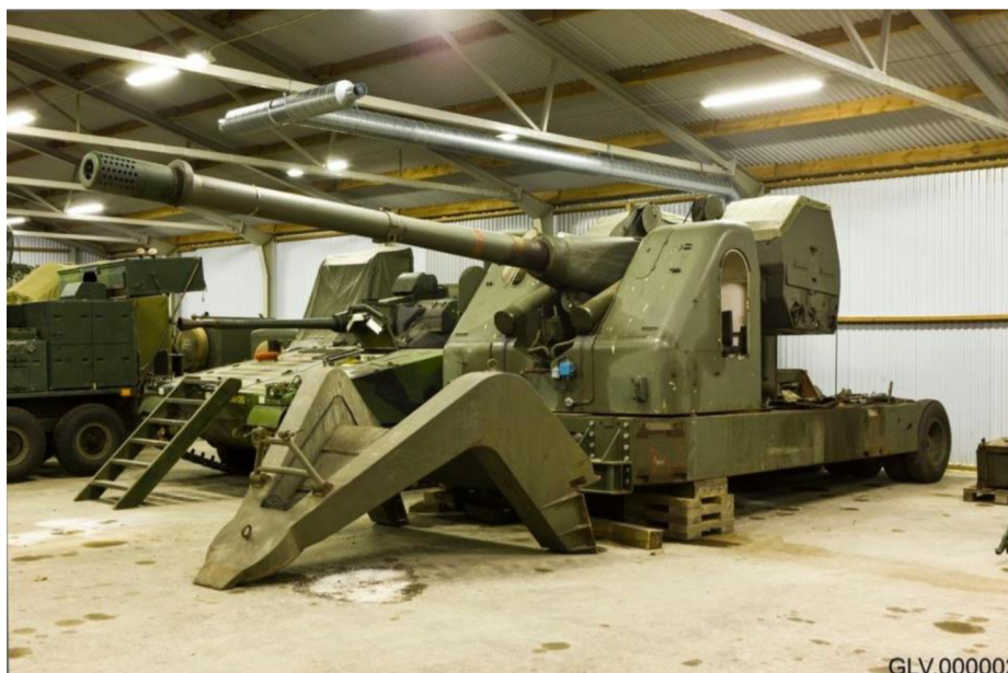
Obr.2 Velkorážné dělo s kompenzátorem zdvihu [2]
