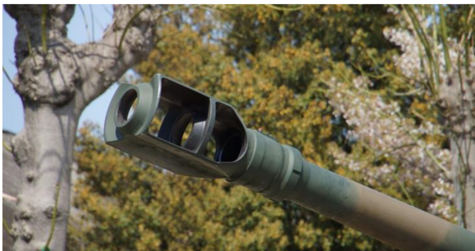
Obr.1 Ústí houfnice s úst'ovou brzdou [1]
