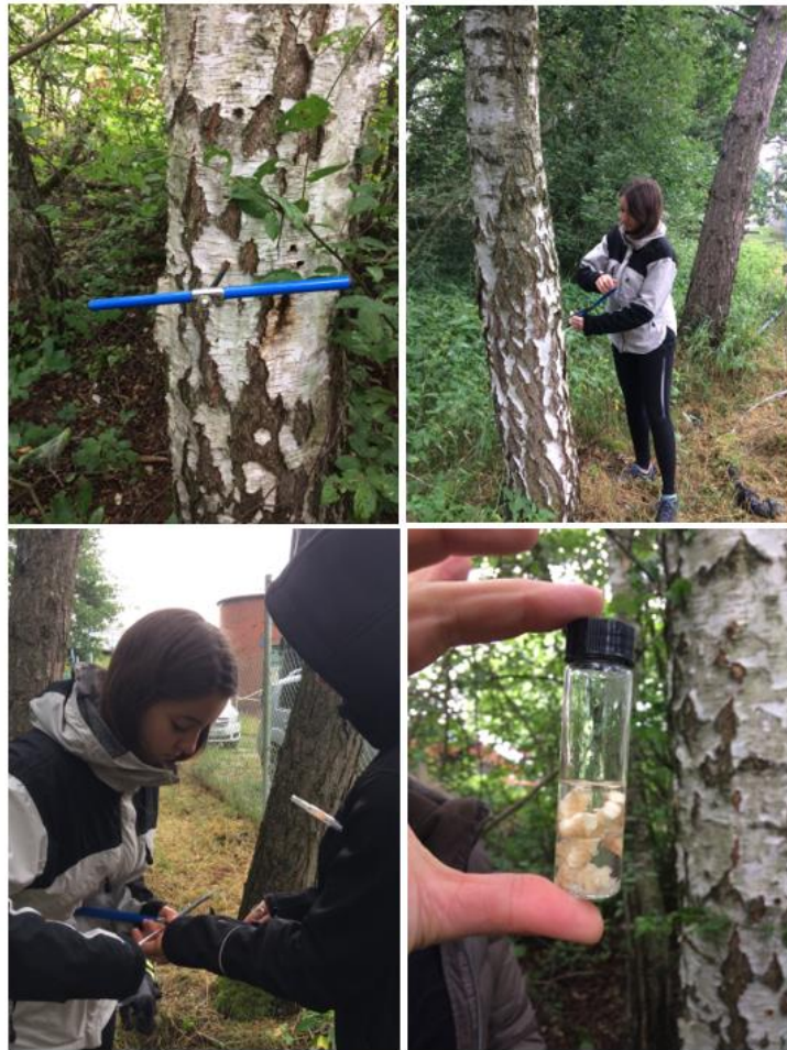
Obrázek 2 Metodický postup odběru vzorku dřeva – konzervace destilovaná voda
