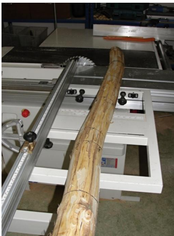
Obr. 13 Odkorněná polovina výřezu po vysušení s označenými budoucími segmenty (foto autor)
