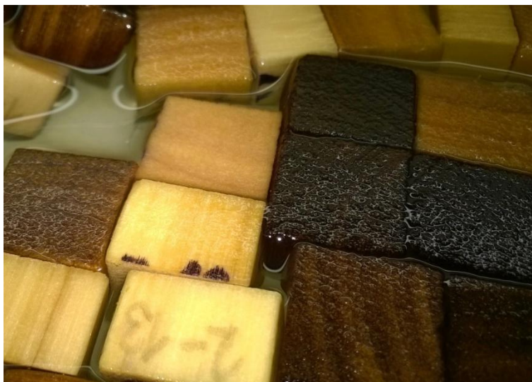
Obr. 43 Fotografie z testu bobtnání a ztráty hmotnosti vlivem vyluhování při namočení vzorků v destilované vodě (foto autor)
