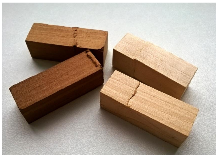
Obr. 45 Fotografie porušených a deformovaných vzorků po provedení testu pevnosti ve směru vláken (foto autor)
