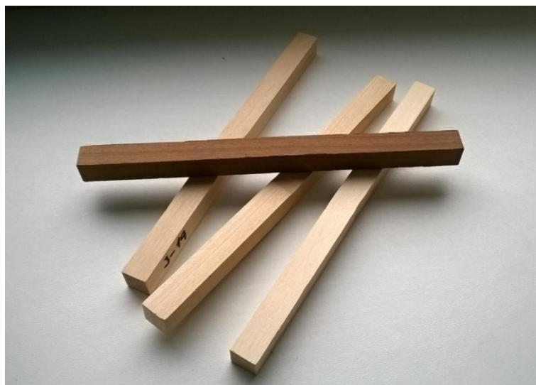
Obr. 24 Vzorky připravené pro zkoušku ve statickém ohybu (foto autor)
