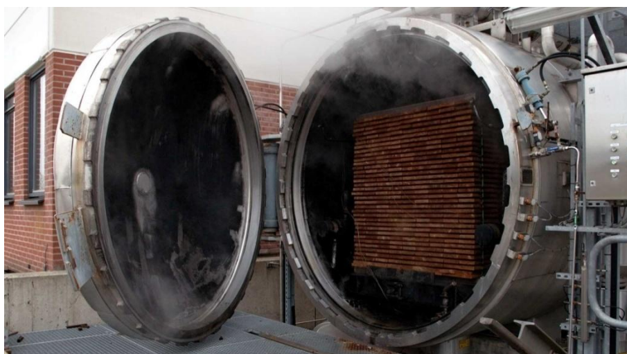
Obr. 3 Nerezový reaktor pro hydrotermolýzu dřeva (PlatoWood)
