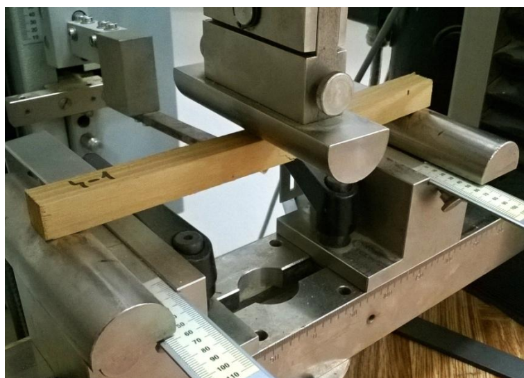
Obr. 44 Fotografie situace při měření pevnosti ve statickém tříbodém ohybu na univerzálním zkušebním stroji ZwickZ050 s extenzometrem pro snímání deformací (foto autor)
