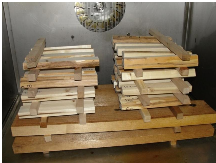
Obr. 23 Hrubé přířezy narovnané do hrání v komoře po tepelné modifikaci (foto autor)
