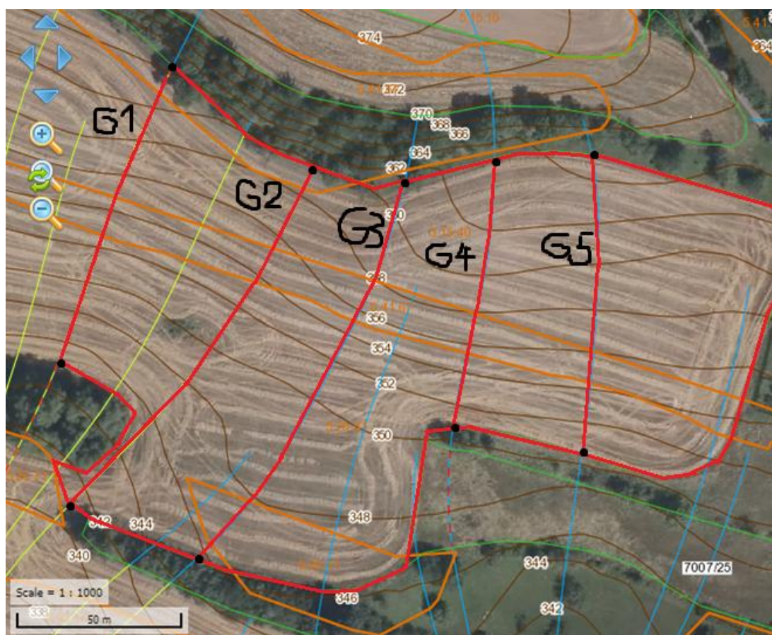
Obrázek 10 - Mapa z LPIS, dokreslená hranice území a dle odtokových linií stanovené profily pro výpočet rýžkové eroze, začátek a konec profilu značí černé tečky (LPIS ©2018).
