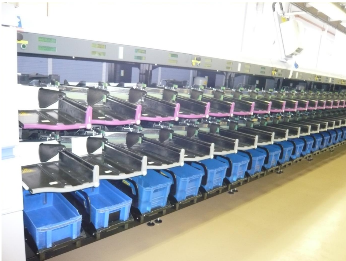
Obrázek č. 27a Zásobník s tiskárnou svazovek, jednotlivé přihrádky a přepravky na vytříděné zásilky
