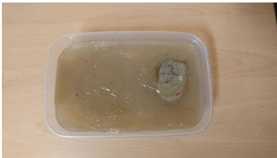
Obr. 25 Fantom znehodnocený terapeutickým ultrazvukem (Zdroj: autor)
