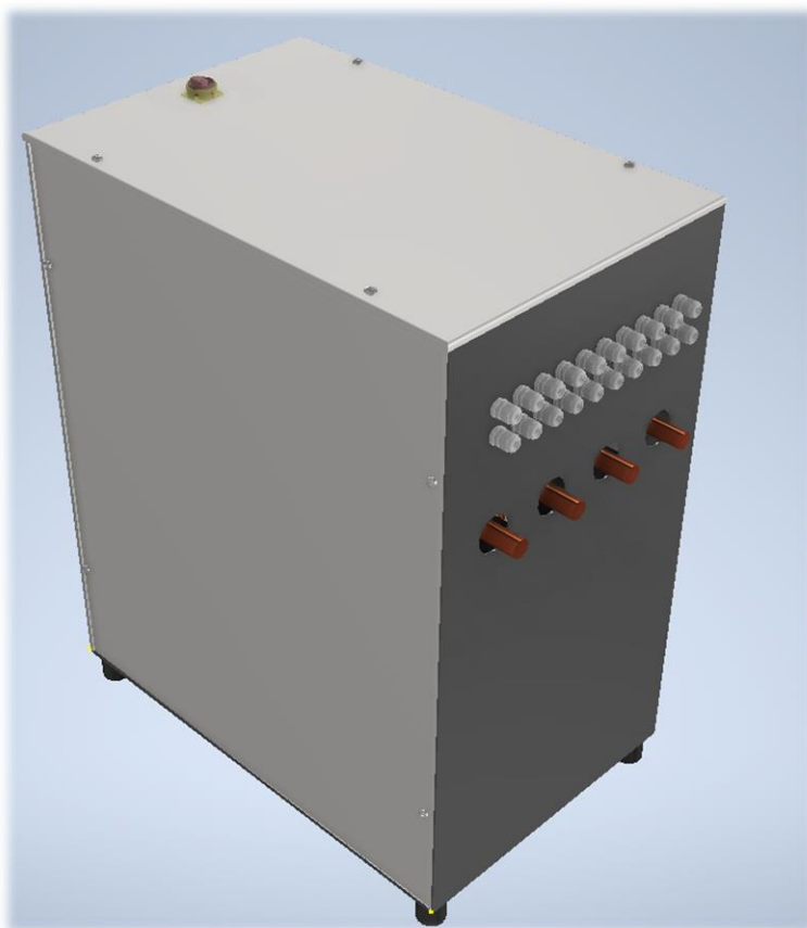
Obr. 2.20 Kompletní návrh tepelného čerpadla, pohled zezadu
