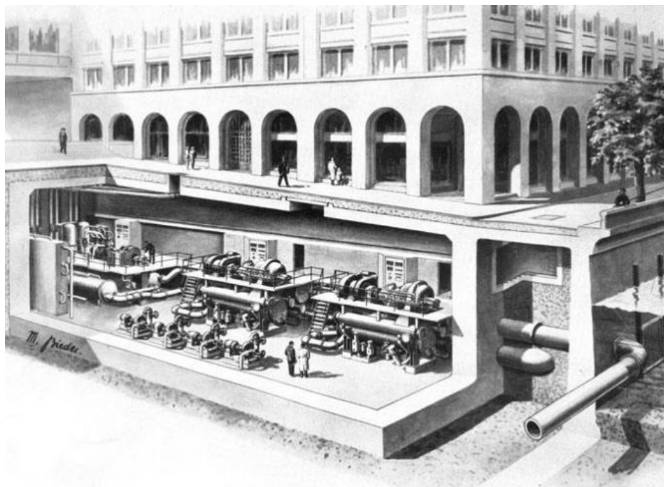
Obr. 1.1 TČ voda/voda o výkonu 5,8MW, Walche 1942 [4]
