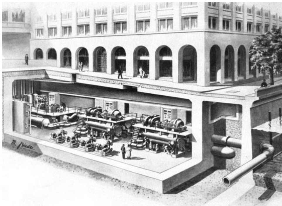
Obr. 1.1 TČ voda/voda o výkonu 5,8MW, Walche 1942 [4]
