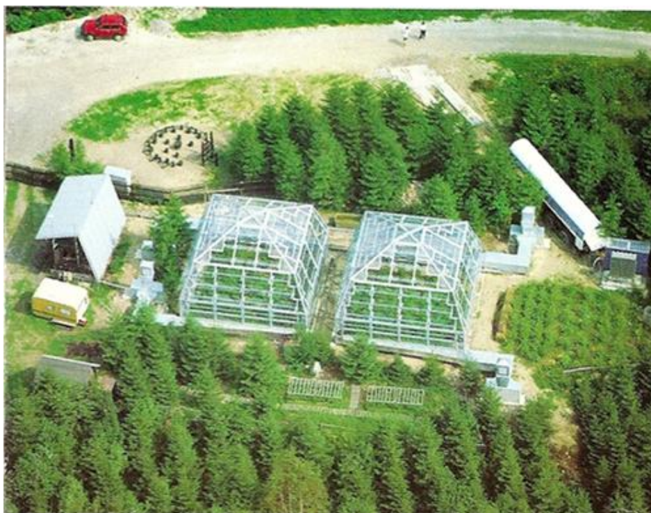
Obr. 3.1 Kultivační minisféry Experimentálního ekologického pracoviště Centra pro výzkum globální změny Akademie věd ČR na Bílém Kříži. Vlevo minisféra s normální koncentrací, vpravo minisféra se zvýšenou koncentrací \text{CO}_2 . Převzato z [63].
