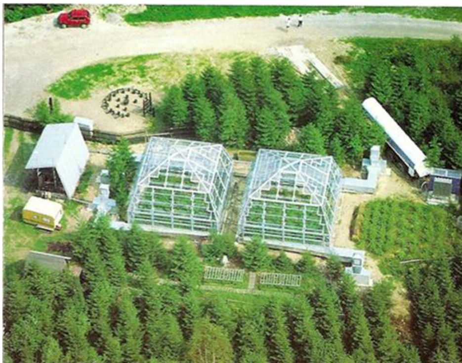
Obr. 3.1 Kultivační minisféry Experimentálního ekologického pracoviště Centra pro výzkum globální změny Akademie věd ČR na Bílém Kříži. Vlevo minisféra s normální koncentrací, vpravo minisféra se zvýšenou koncentrací CO_2 . Převzato z [63].
