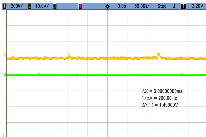
Obrázok 5.10 Zníženie prekmitu spôsobeného multiplexovaním
