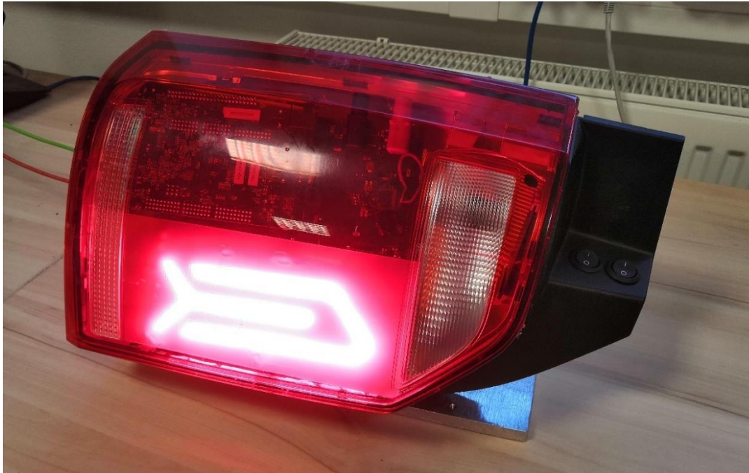
Obrázok 8.9 Prototyp umiestený vo svetlomete
