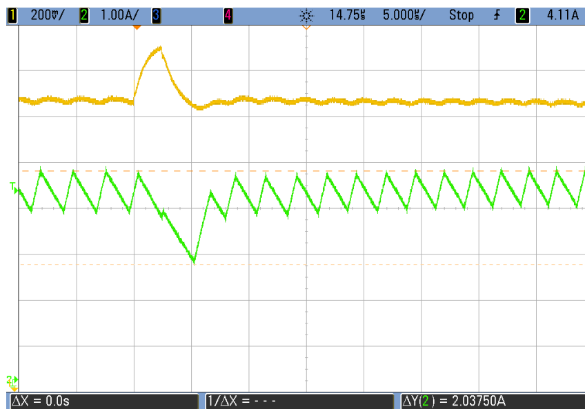
Obrázok 5.9 Prekmit výstupného napätia pri multiplexovaní
