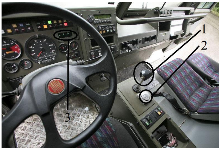
Obr. 12 Pohled do kabiny vozidla vybaveného posilovačem Norgren [3]
