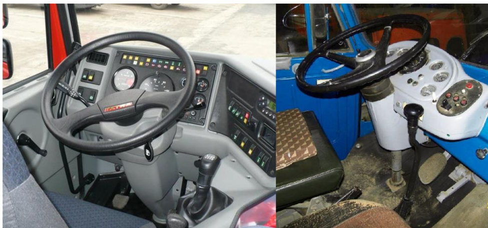
Obr. 11 Porovnání délky řadicí páky, vlevo Tatra FORCE, vpravo Tatra 138 [1]
