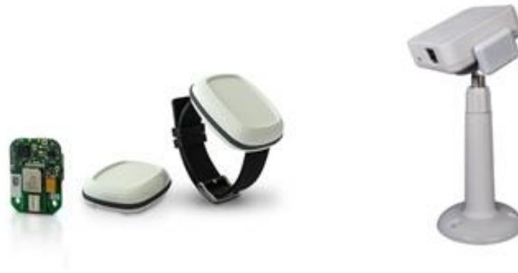
Obrázek 15 Příklad tagů a kotvy RTLS
