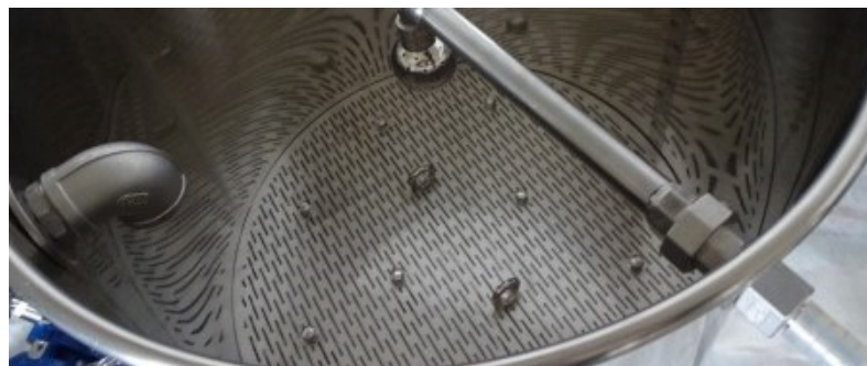
Obrázek 13: nerezové frézované scezovací dno (15)
