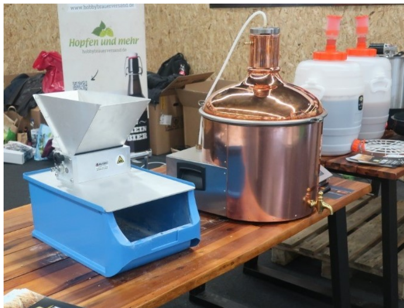
Obrázek 5: Příklad jednonádobové varny z výstavy BrauBeviale 2019
