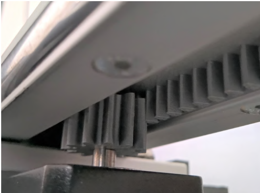
Obrázek 4.16: Detail tištěného ozubeného spojení krokového motoru s lineárním posuvem, přes ozubení umístěné do drážky posuvu.
