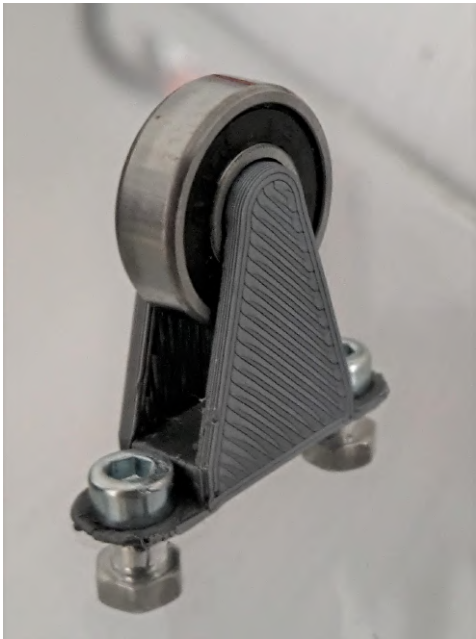
Obrázek 4.14: Valivé ložisko s tištěným úchytem pro uložení rotační platformy.
