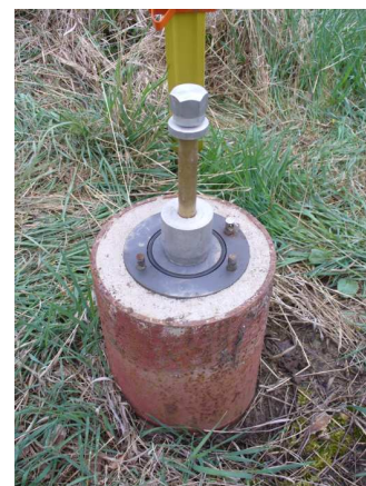
Obr. 2: stabilizace bodu se zasunutým centračním prvkem
