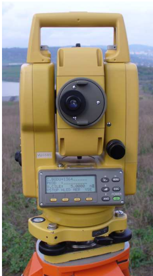
Obr. 6: totální stanice Topcon TCN 2006 (zdroj: [vlastní])
