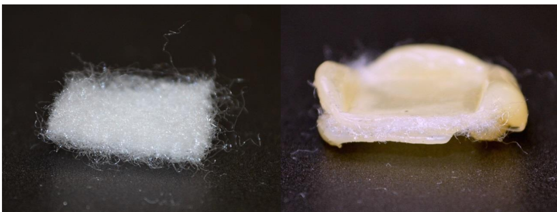
Obrázek 61: Lehká vpichovaná textilie, vlevo volná, vpravo po aplikaci
