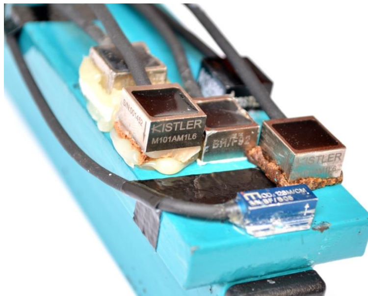
Obrázek 44: Montážní plocha osazená snímači zrychlení, montážní způsob zprava: včelí vosk, vteřinové lepidlo, Tesa Powerstrips, tavná tyčinka s korkovou destičkou
