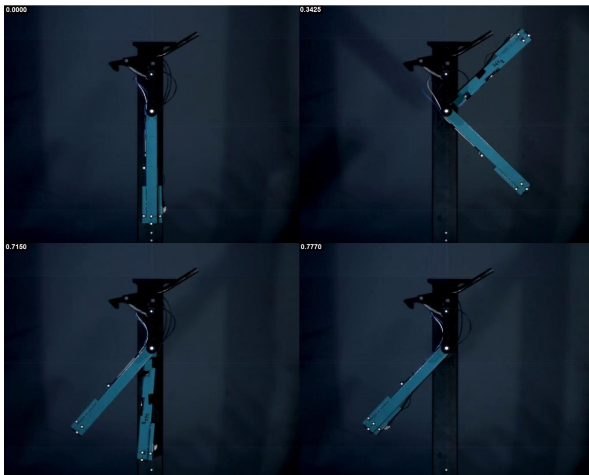
Obrázek 45: Charakteristické polohy dvojice kyvadel, levý horní - okamžik počátečního rázu, pravý horní - maximální vychýlení kyvadla se snímači, levý dolní - průchod nulovou hodnotou, pravý dolní - druhý ráz kyvadel
