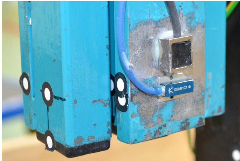
Obrázek 54: Připevnění akcelerometrů na kyvadle
