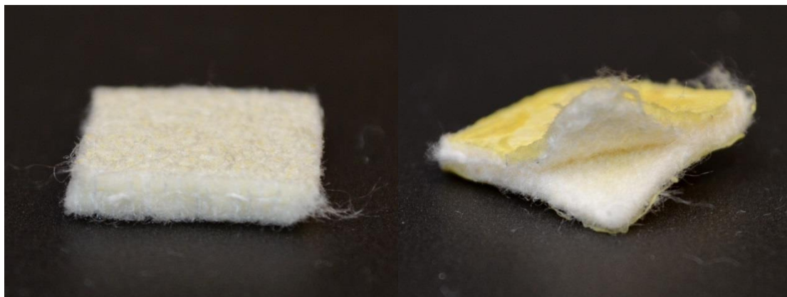
Obrázek 64: Vpichovaná těžká pojená textilie, vlevo volná, vpravo viditelný prosak chemoprenu
