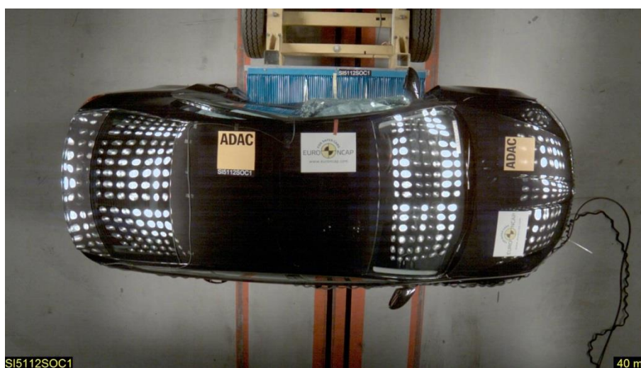
Obrázek 18: Skutečný průnik deformovatelné bariéry do struktury vozu; [26]
