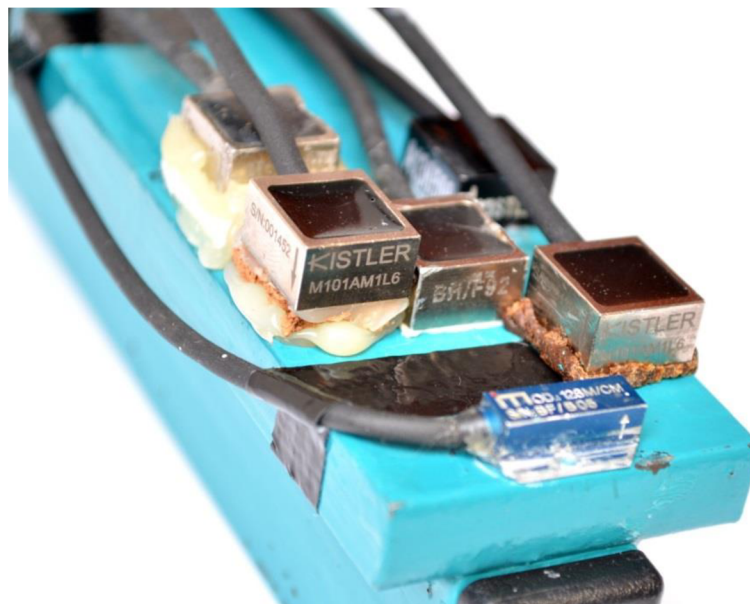
Obrázek 44: Montážní plocha osazená snímači zrychlení, montážní způsob zprava: včeli vosk, vteřinové lepidlo, Tesa Powerstrips, tavná tyčinka s korkovou destičkou
