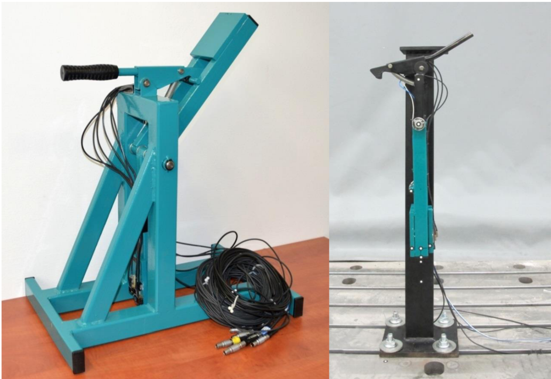
Obrázek 43: Vlevo původní rázové kyvadlo, vpravo přepracovaná stojná noha
