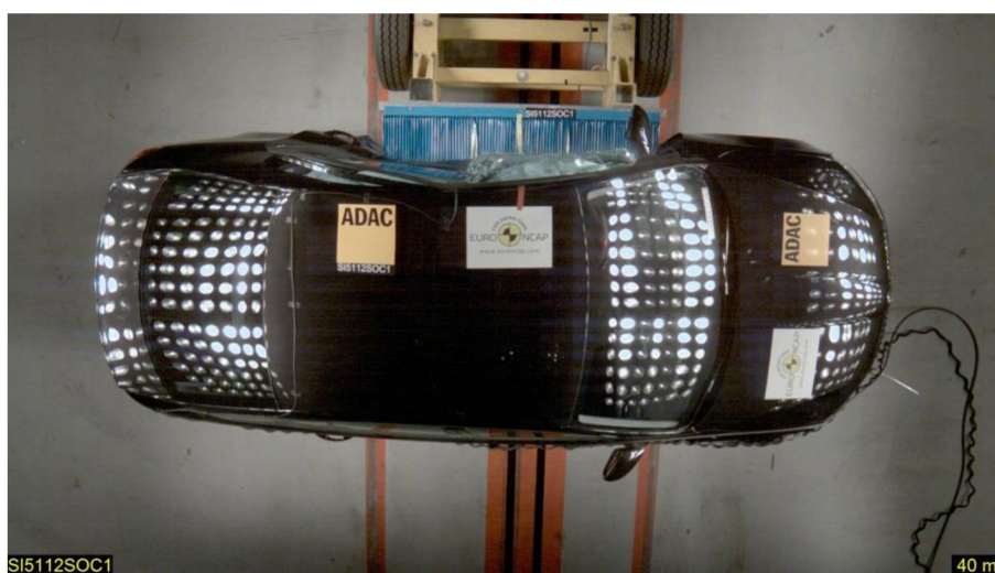
Obrázek 18: Skutečný průnik deformovatelné bariéry do struktury vozu; [26]
