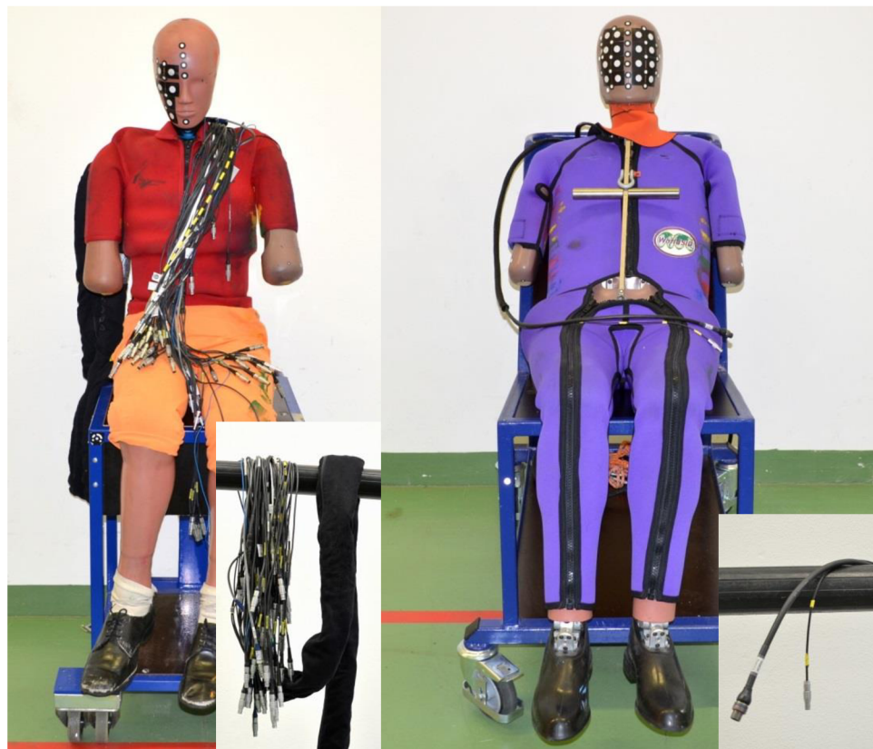
Obrázek 12: Vlevo figurína ES-2 s detailem kabelového svazku, vpravo figurína WorldSID vybavená In-Dummy
