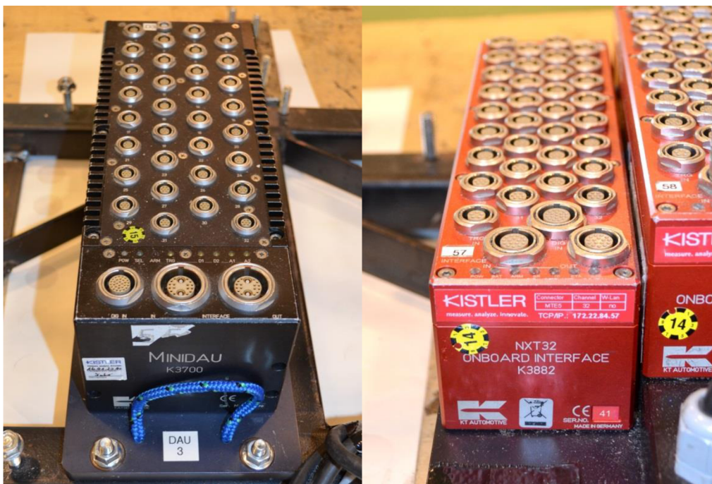
Obrázek 8: Vlevo Black box jednotka Kayser-Threde Minidau K3700, vpravo Kidau Basic 3882
