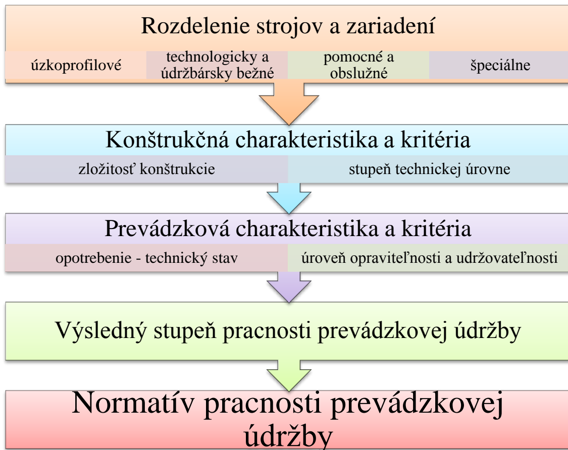
Obrázok č. 14: Algoritmus tvorby noratívov u strojov a zariadení (Zdroj: Vlastné spracovanie podľa (10))
