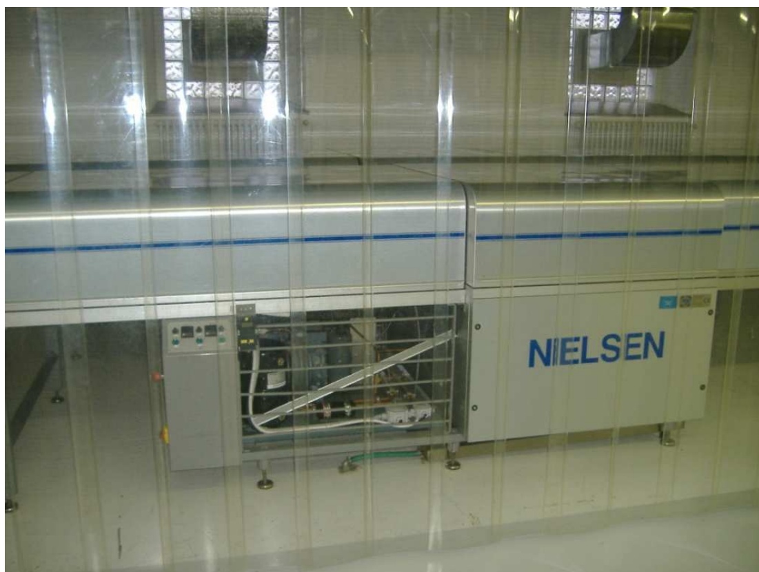
Obr. 8 Chladící tunel – boční pohled [14]
