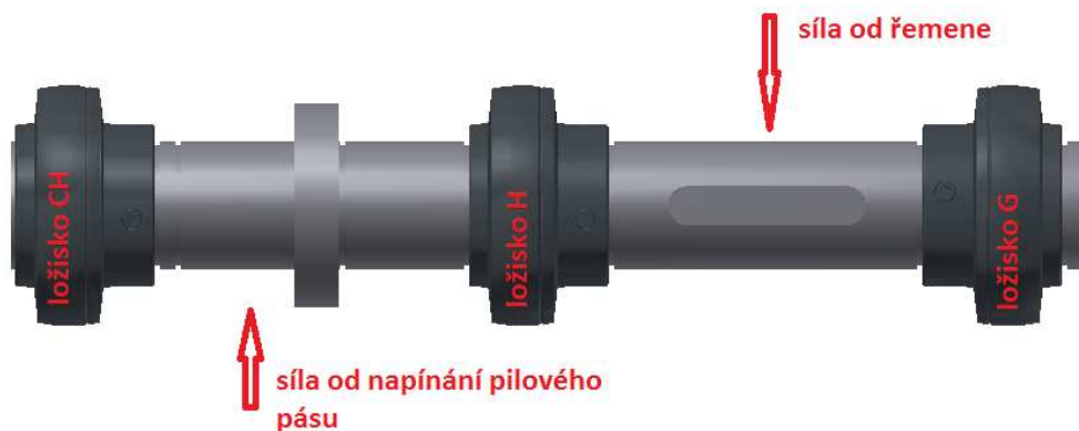
Obrázek 33 - hřídel hnané řemenice (okrajové podmínky)
