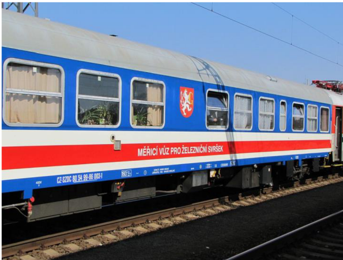
Obrázek 2-2: Měřicí vůz pro železniční svršek; zdroj: wiki
