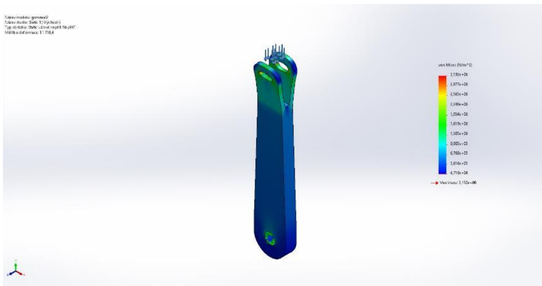
Obrázek č. 122: Napětí ojnice přemíst'ovacího typu Gama
