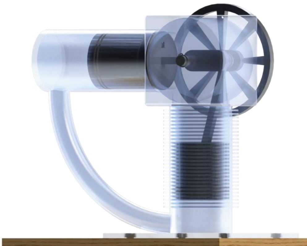
Obrázek č. 82: Sestavený Stirlingův motor typu Alfa
