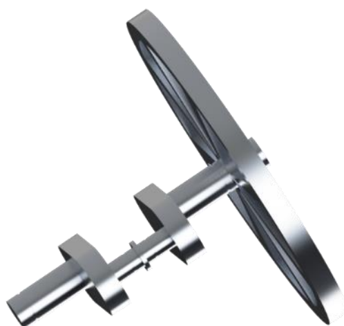
Obrázek č. 22: Výkres klikové hřídele se setrvačníkem typu Alfa
