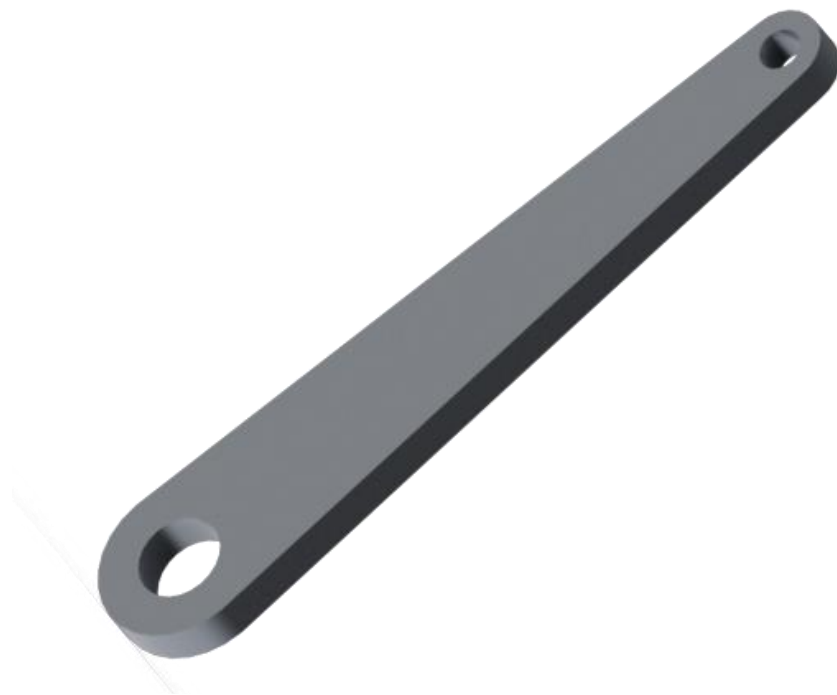
Obrázek č. 31: Realistické znázornění ojnice pracovního pístu typu Beta
