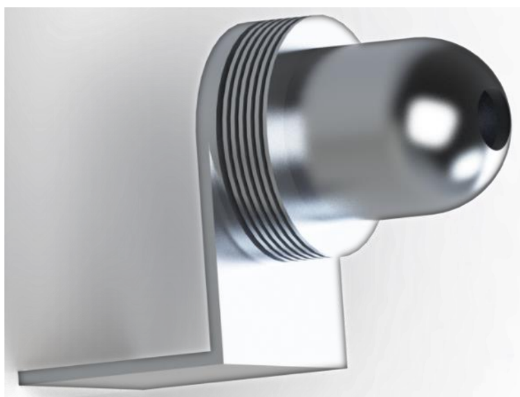
Obrázek č. 58: Realistické znázornění válce pro přemísťovací píst typu Gama
