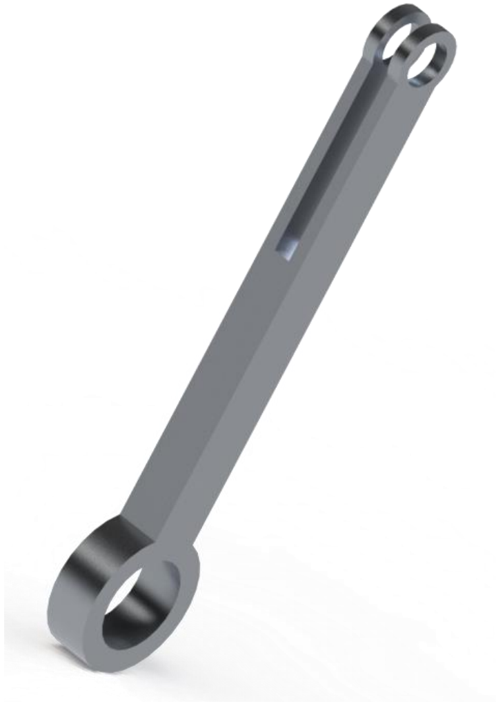
Obrázek č. 33: Realistické znázornění ojnice přemísťovacího pístu typu Beta
