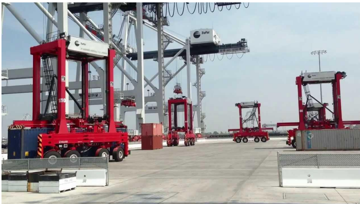
Obr.4 ALV při pojíždění v kontejnerovém terminálu [11]
