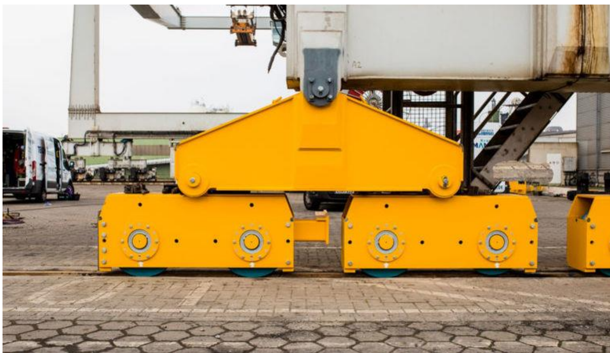
Obr.10 Kolejový podvozek portálového jeřábu typu RMG [16]
