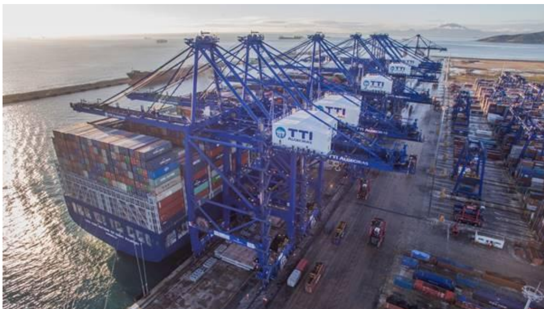
Obr.5 Vykládání kontejnerů pomocí nábřežních jeřábů [12]
