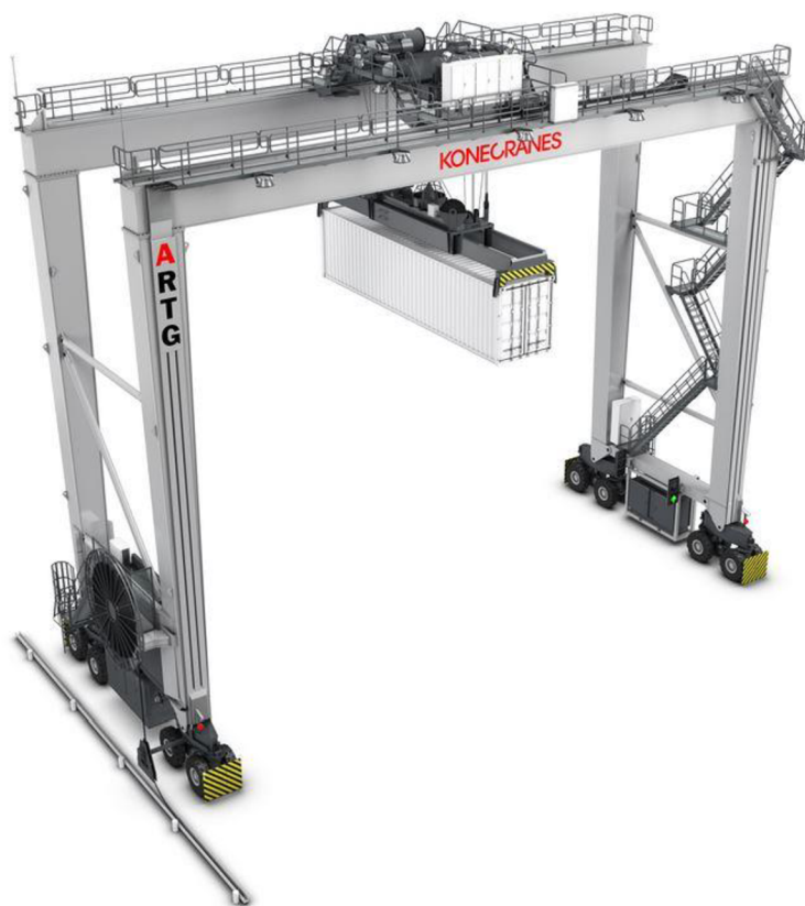
Obr.7 RTG portálový jeřáb s pneumatickým podvozkem [13]
