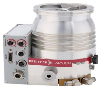
Obr. 4 Turbomolekulárna výveva typu Pfeiffer Hipace 700+ používaná v UHV-SEM, zdroj [21].
