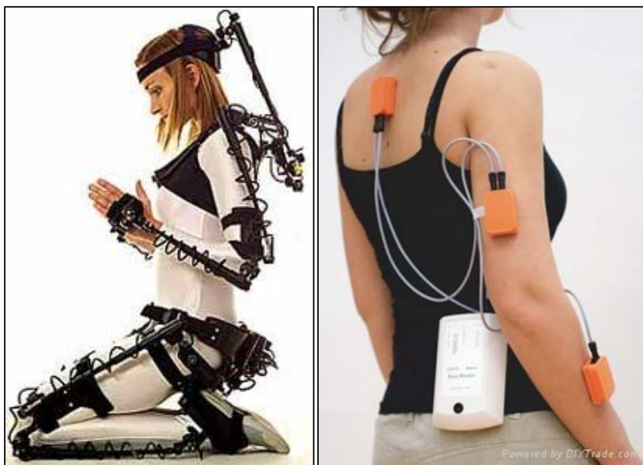
Obrázek 2.1.1 Exoskelet mechanického systému a senzory inerciálního systému [25]
