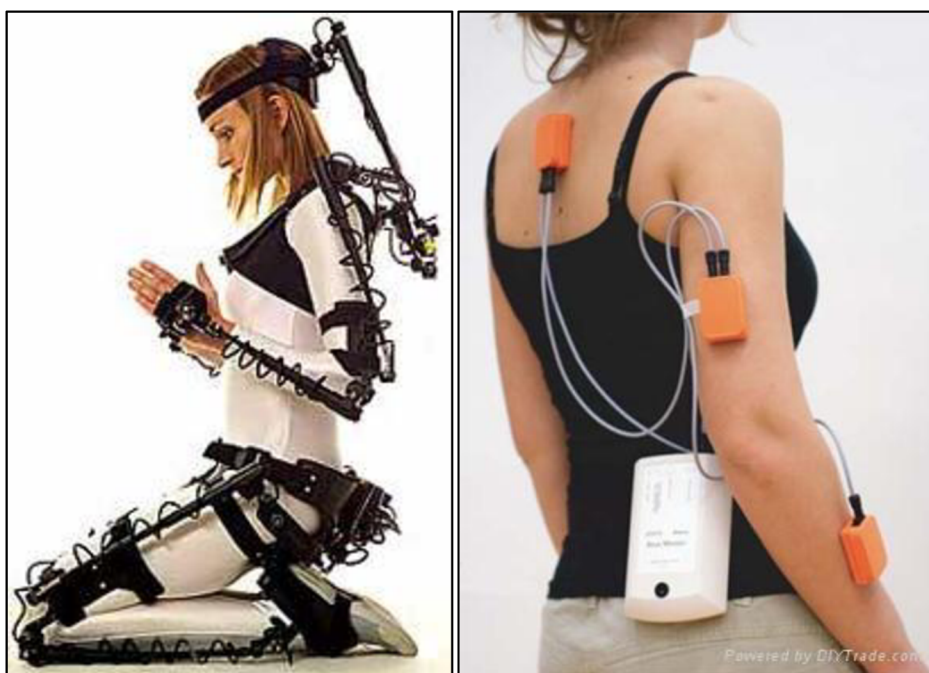
Obrázek 2.1.1 Exoskelet mechanického systému a senzory inerciálního systému [25]
