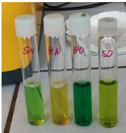
Obrázok 7: Stanovenie amoniakálneho dusíka (vlastná fotografia)
