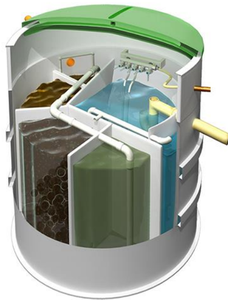
Obrázok 5: Schéma usporiadania jednotlivých komôr v DČOV firmy ZAKRA [26]
