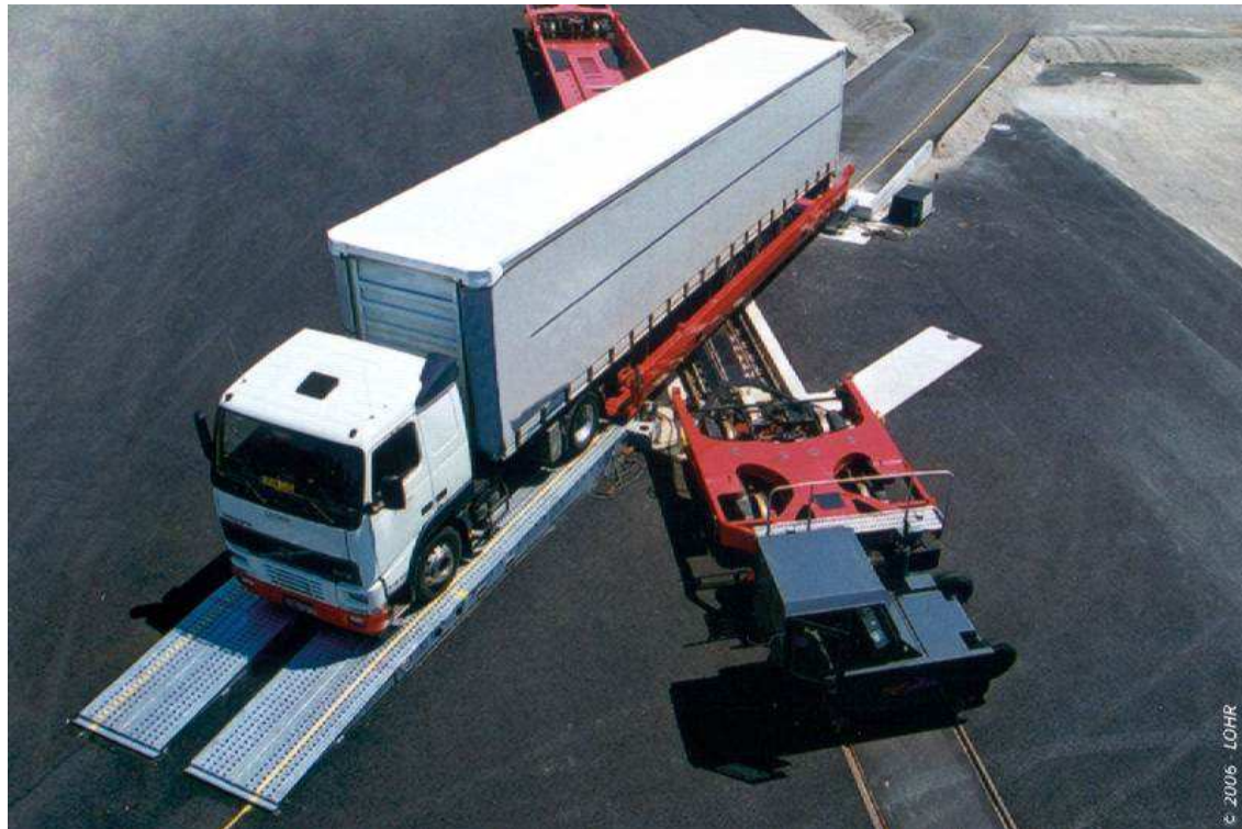
obr. 8 Způsob překládky systémem Modalohr [10]
