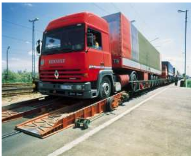
obr. 5 Nakládka a vykládka v systému RoLa
