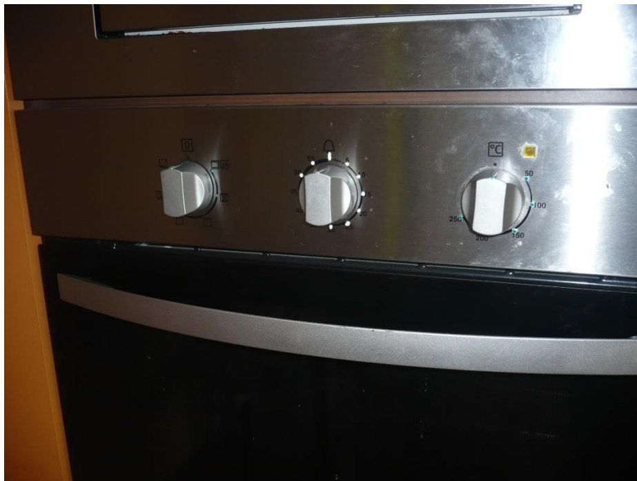
Obrázek 14: Mechanické regulátory popsané konturační hmotou
