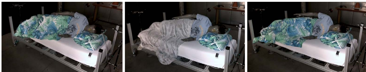
Obrázek 7.4: Tepelný manekýn během testu různých přikrývek v poloze na boku, zleva letní přikrývka, deka a bavlněný potah
