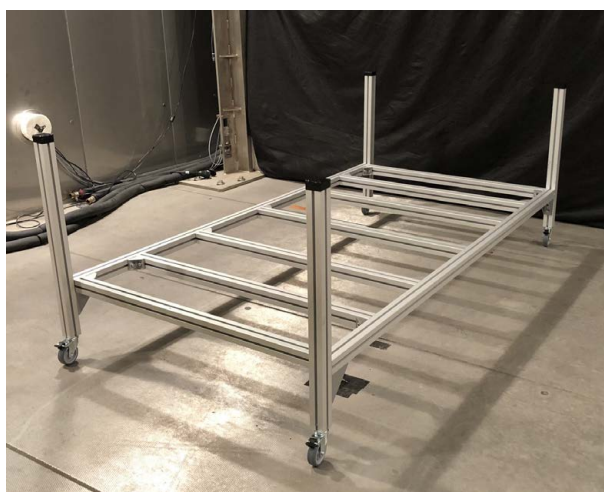
Obrázek 7.7: Hotové provizorní lůžko umístěné v klimatické komoře
