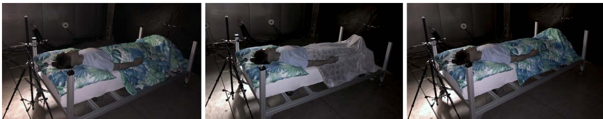
Obrázek 7.2: Tepelný manekýn během testu různých přikrývek, zleva letní přikrývka, deka a bavlněný potah.
