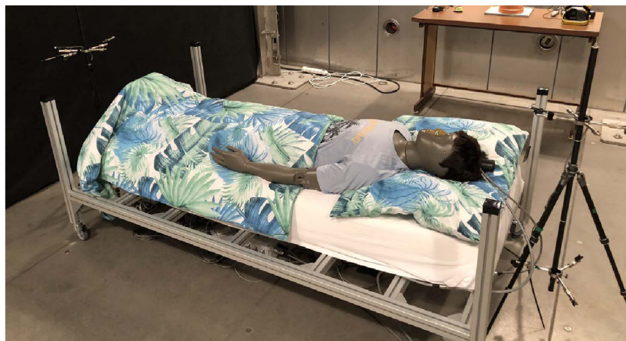
Obrázek 8.5: Uložení tepelného manekýna v klimatické komoře před začátkem experimentu
