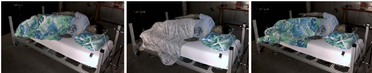
Obrázek 7.4: Tepelný manekýn během testu různých přikrývek v poloze na boku, zleva letní přikrývka, deka a bavlněný potah
