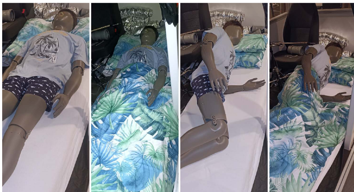
Obrázek 8.1: Fotodokumentace z pretestu v kabinsimulátoru ukazující měřené případy s přikrývkou a bez přikrývky při poloze na zádech a na boku
