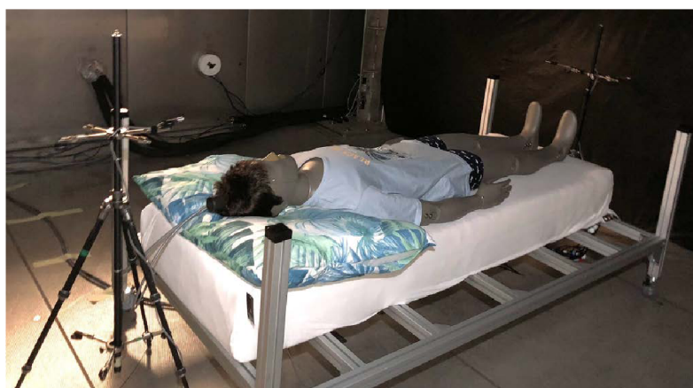
Obrázek 7.1: Základní nastavení experimentu pro měření tepelných odporů různých spacích sestav.
