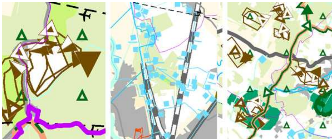
Obr. 4.6 Vizualizační problémy: 1. nerozeznatelné vrstvy, 2. pro dané měřítko špatně zvolený znakový klíč, 3. polygony menší než bodový znak.
