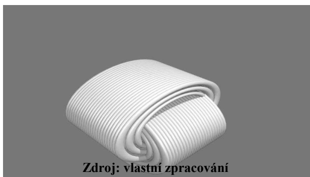
Obrázek 3.7 Skládání kabeláže bez použití bubnů
