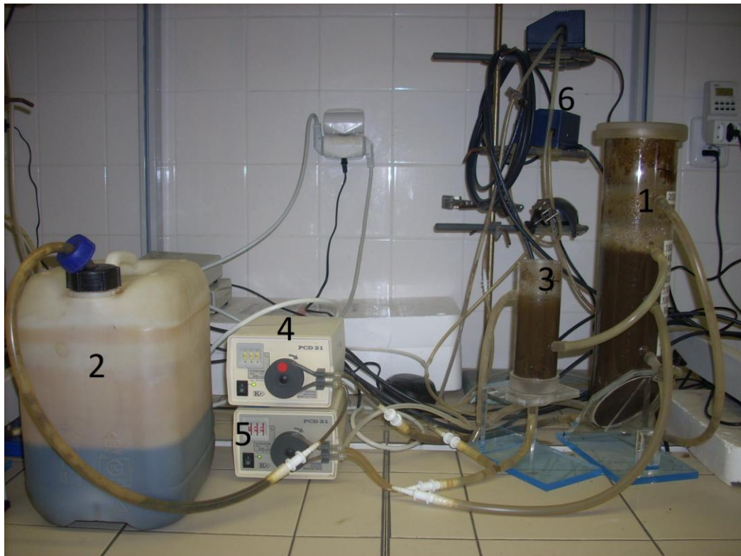
1) reaktor, 2) vstupní kalová voda, 3) dosazovací nádrž, 4) peristaltické čerpadlo vstupní kalové vody, 5) peristaltické čerpadlo recirkulace kalu, 6) vzduchovací motorek
