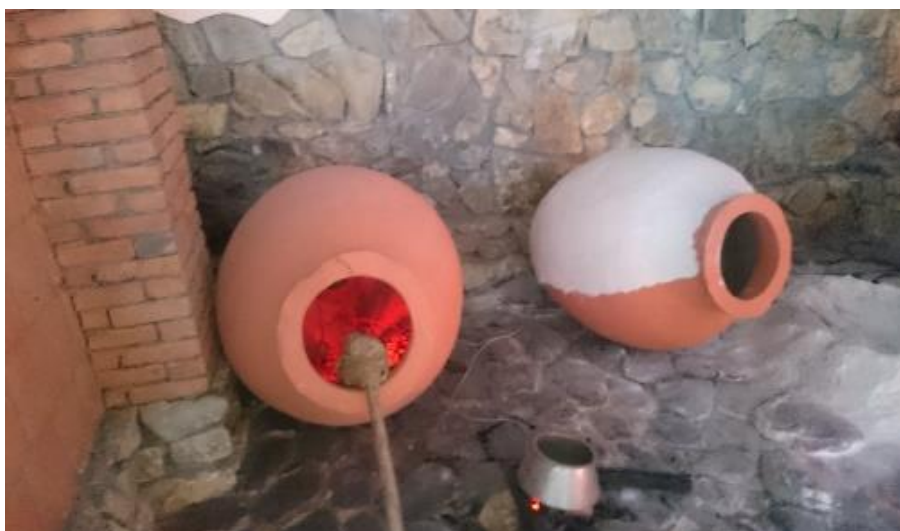
Obr. 9 Ošetření včelím voskem a vápnem po vypálení (přednáška TSV, Mojmír Baroň, 2016)
