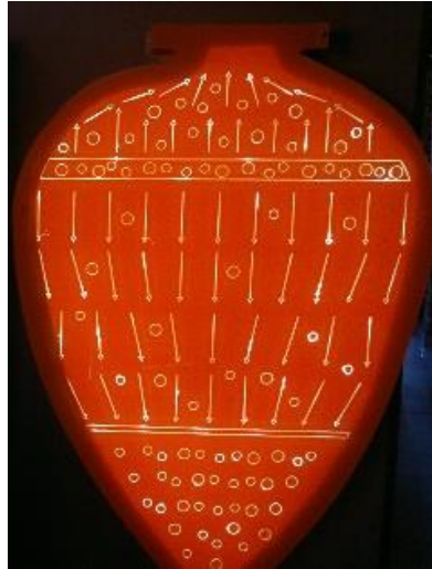
Obr. 8 Znárodnění samovolného míchacího procesu při fermentaci. (přednáška TSV, Mojmir Baroň, 2016)
