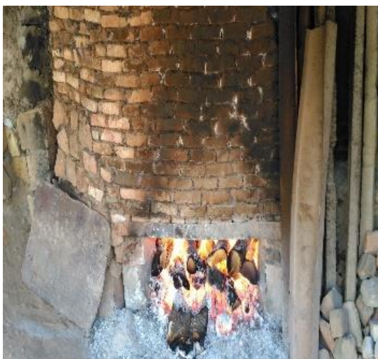
Obr. 4 Vlastnoručně vyrobená pec na vypalování vysušených kvevri (foto autor)
