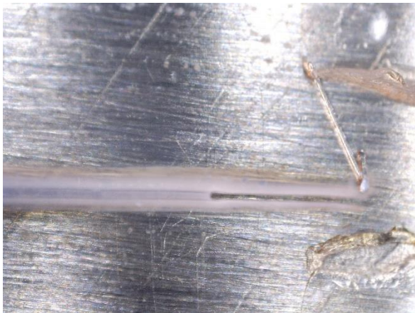
Obrázek 17: Snímek 4.1 - Struktura tavené vrstvy tenkého vlákna.
