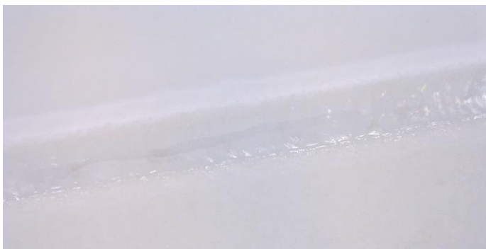
Obrázek 19: Snímek 3.4 - Roztavený sklokeramický podklad včetně vlákna ve dvou spojitých vrstvách.
