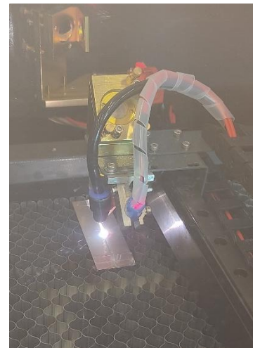
Obrázek 2: Fotografie hlavy gravírovacího zařízení s CO 2 laserem.
