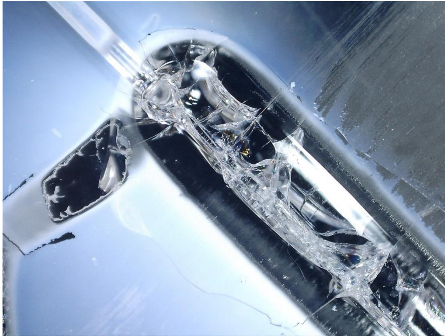
Obrázek 21: Snímek 3.5 - Natavené skelné vlákno na prasklé laboratorní destičce s černým podkladem.
