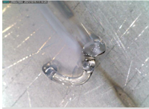
Obrázek 15: Snímek 2.10 - Zkroucené vlákno.
