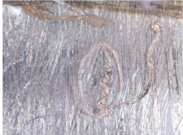
Obrázek 18: Snímek 4.3 - Napětím srolované vlákno.
