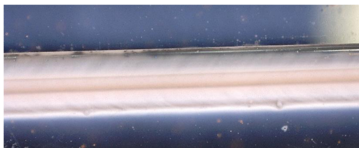
Obrázek 22: Snímek 3.1 - Natavená plocha se zbylým pozůstatkem jádra ve středu.
