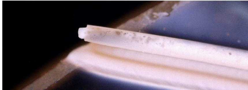
Obrázek 23: Snímek 3.2 - Snímek zjevného rozdílu v pozici vlákna a nataveného skla
