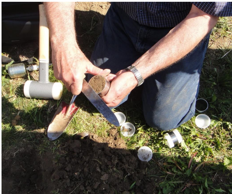
Obr. 9: Odběr neporušeného půdního vzorku (hydropedologie.agrobiologie.cz)
