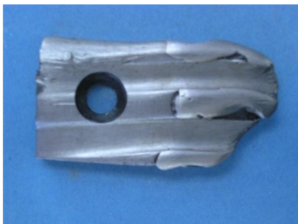
Obr. 54 Opotřebený vzorek (kombinace OK 8350 + 15 230 popuštěno)
