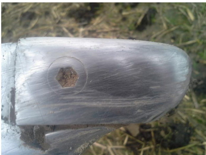
Obr. 51 Opotřebovaný vzorek po ujetí 8 ha na pluhu
