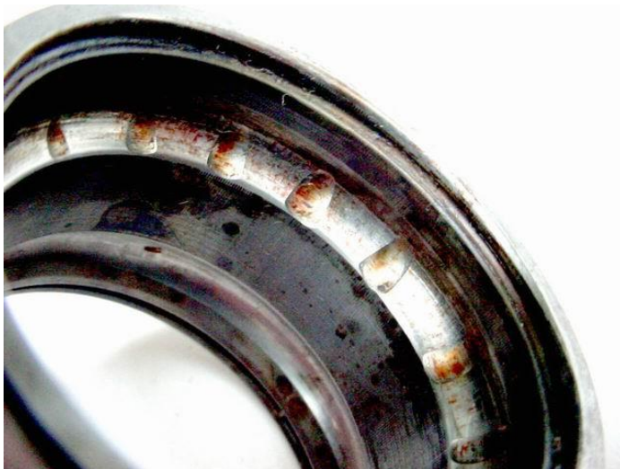
Obr. 23 Vibrační opotřebení ložiska ( http://degradace.tf.czu.cz )
