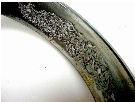
Obr. 22 Únavové opotřebení kroužku ložiska ( http://degradace.tf.czu.cz )
