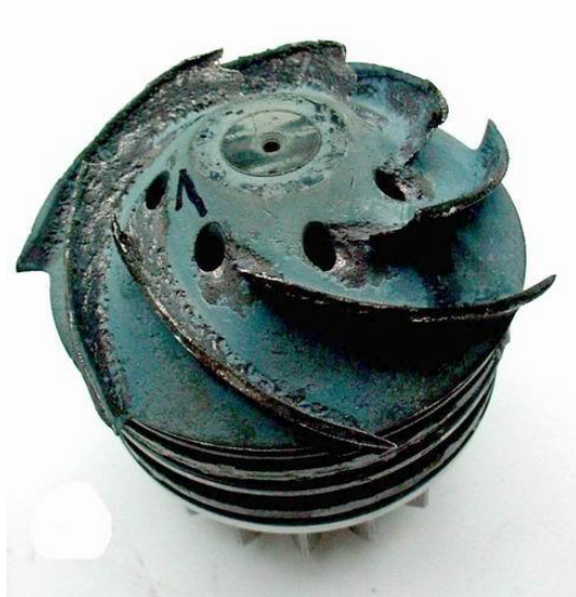
Obr. 21 Kavitační opotřebení lopatkového kola ( http://degradace.tf.czu.cz )
