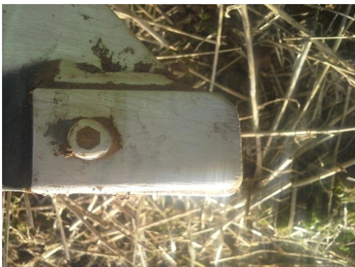
Obr. 50 Opotřebovaný vzorek po ujetí 4 ha na pluhu
