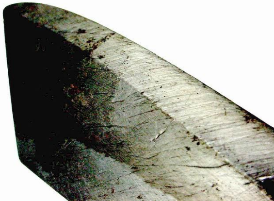
Obr. 24 Abrazivní opotřebení plužní čepel (http://degradace.tf.czu.cz)
