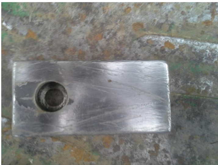
Obr. 48 Měření úbytku hmotnosti vzorku po ujetí 4 ha
