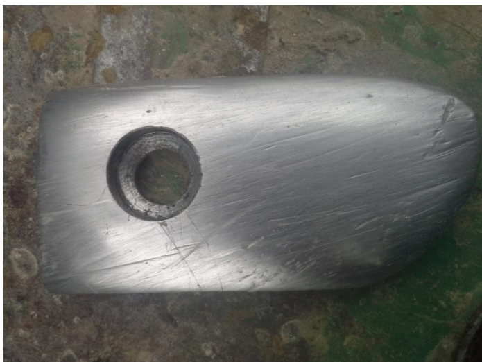
Obr. 49 Měření úbytku hmotnosti vzorku po ujetí 8 ha
