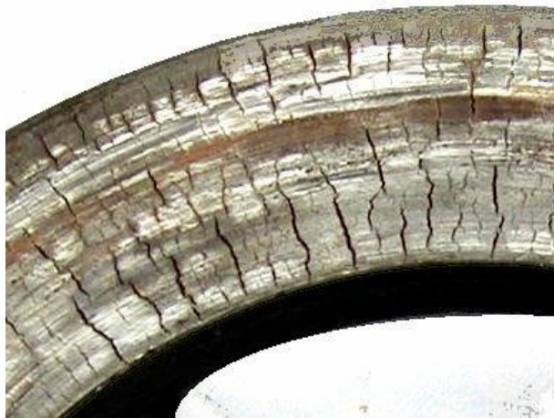
Obr. 19 Adhezivní opotřebení přítlačného kotouče ( http://degradace.tf.czu.cz )
