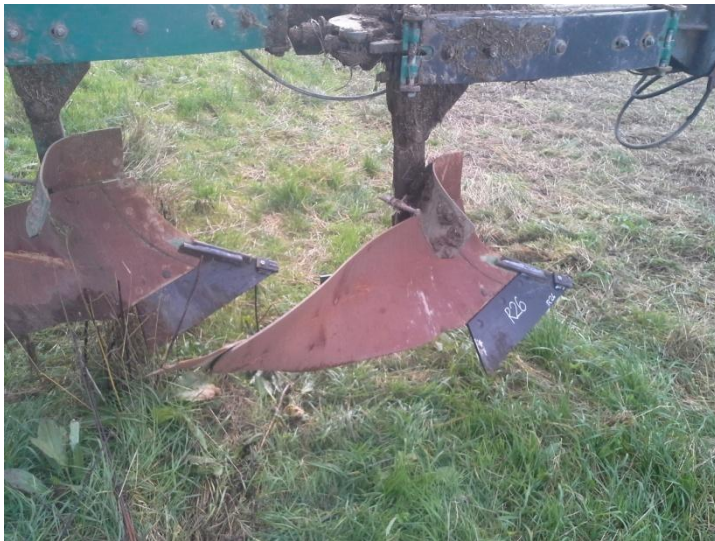
Obr. 47 Umístění zkušebního vzorku na pluhu
