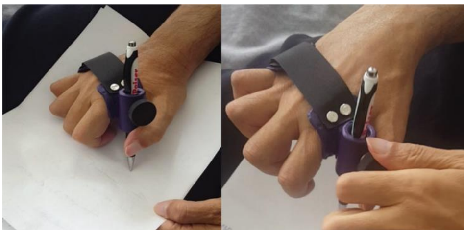
Obrázek 26 Pomůcka vytvořená pomocí 3D skenování a tisku k usnadnění psaní (Degerli, Dogu a Oksuz, 2022, s. 124)
