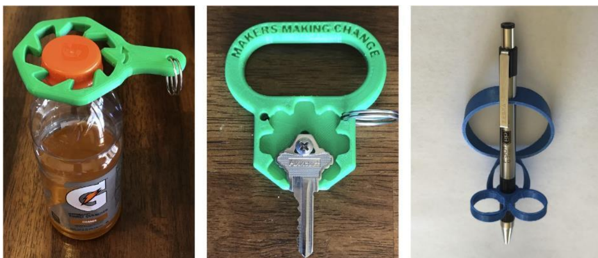
Obrázek 25 Vytisknuté kompenzační pomůcky pro otevírání plastových lahví, manipulaci s klíči a psaní pro osobu s revmatoidní artritidou (Janson et al., 2020, s. 165–166)
