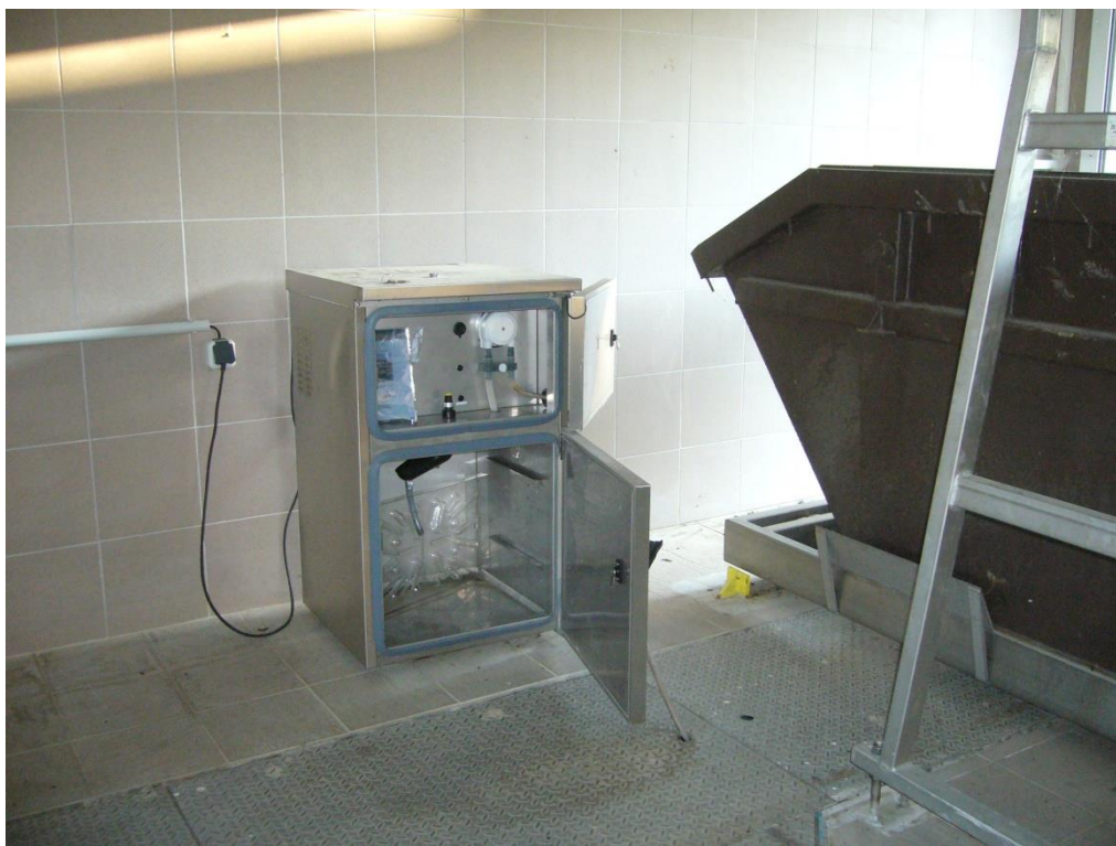
Odběrové zařízení SIMPLY SAMPLER STACIONARY na přítoku [foto autorka]
