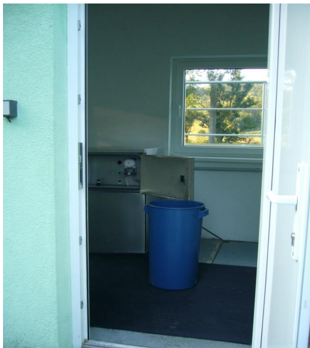
Odběrové zařízení SIMPLY SAMPLER STACIONARY na odtoku [foto autorka]
