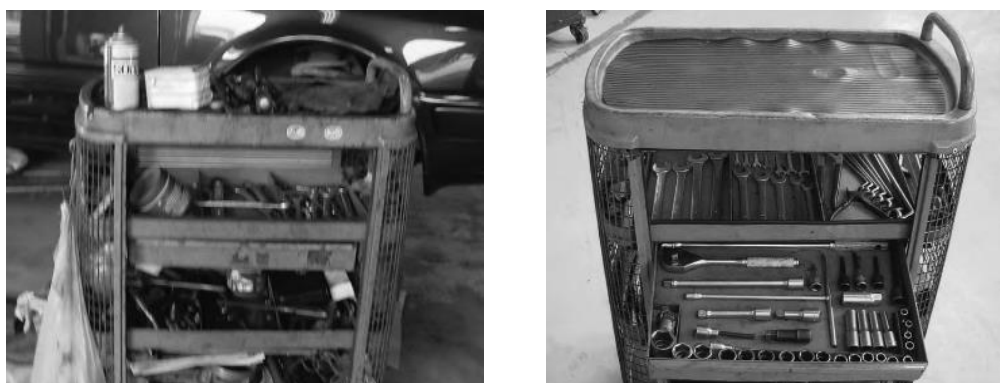
Obrázek 12: Příklad realizace 5S v dílně, PŘED (vlevo), a PO (vpravo) aplikaci (Moulding, 2010)
