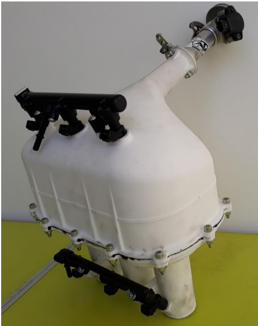
Obr. 65 – Zkompletovaný systém sání před montáží na monopost Formule Student
