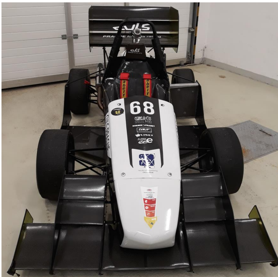
Obr. 67 – Přední pohled na kompletní monopost – škrtková klapka je vidět nad hlavou řidiče, pod vrchní trubkou rámu
