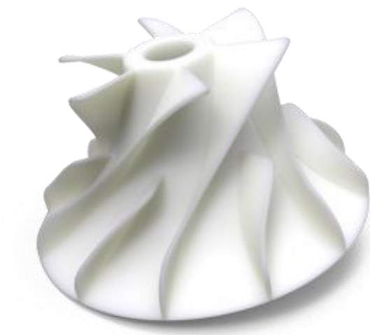
obr. 11 – Výrobek zhotovený metodou SLS, kvalita povrchu je velmi dobrá [23]
