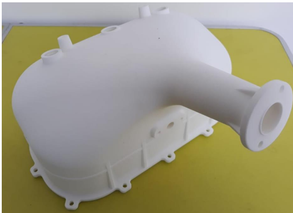
Obr. 63 – Horní díl sání vytisknutý technologií SLS
