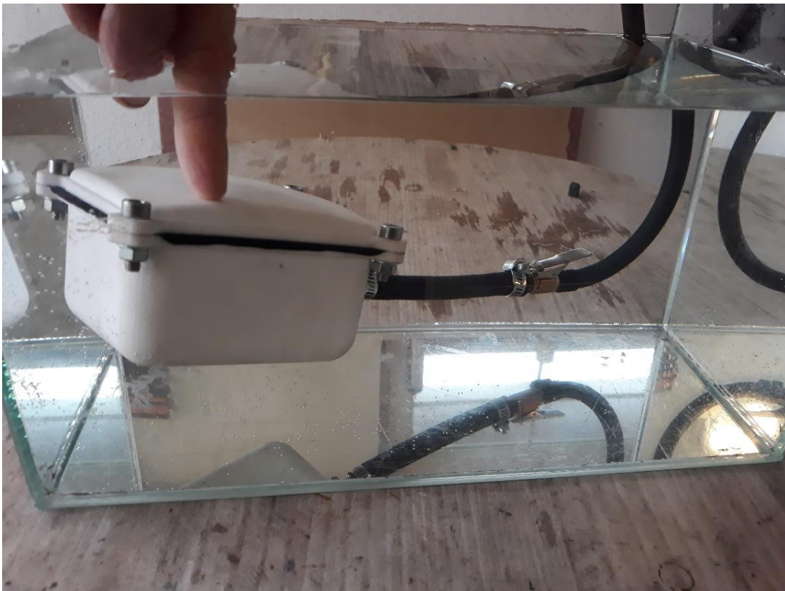
Obr. 17 – Model v nádobě s vodou při tlakové zkoušce
