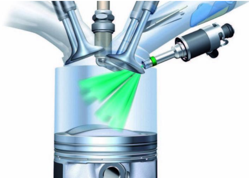
Obr. 6 - Grafické znázornění jednoho válce zážehového motoru s přímým vstřikováním paliva [13]
