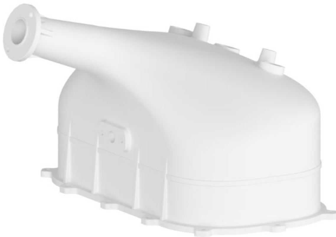
Obr. 43 – Vrchní díl sání, pohled zepředu, je vidět příruba škrtkící klapky a držák senzoru tlaku v sání IAP a držáky vstřikovačů
