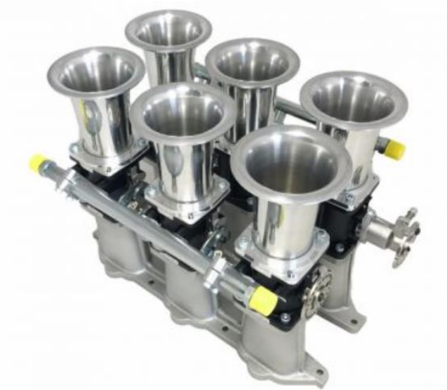
Obr. 32 – Sací potrubí s tvarovanými koncovkami, určeno pro Ford Mondeo ST220 3.0 V6 [33]
