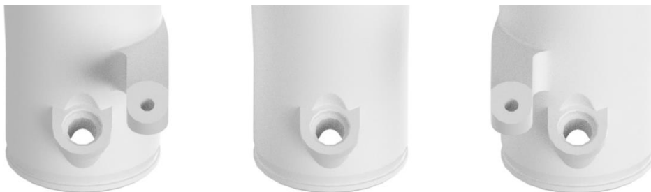
Obr. 28 – Spodní část sání, zakončení sběračů, sedla pro vstřikovače a držáky vstřikovací lišty byly převzaty z originálních škrťících klapek
