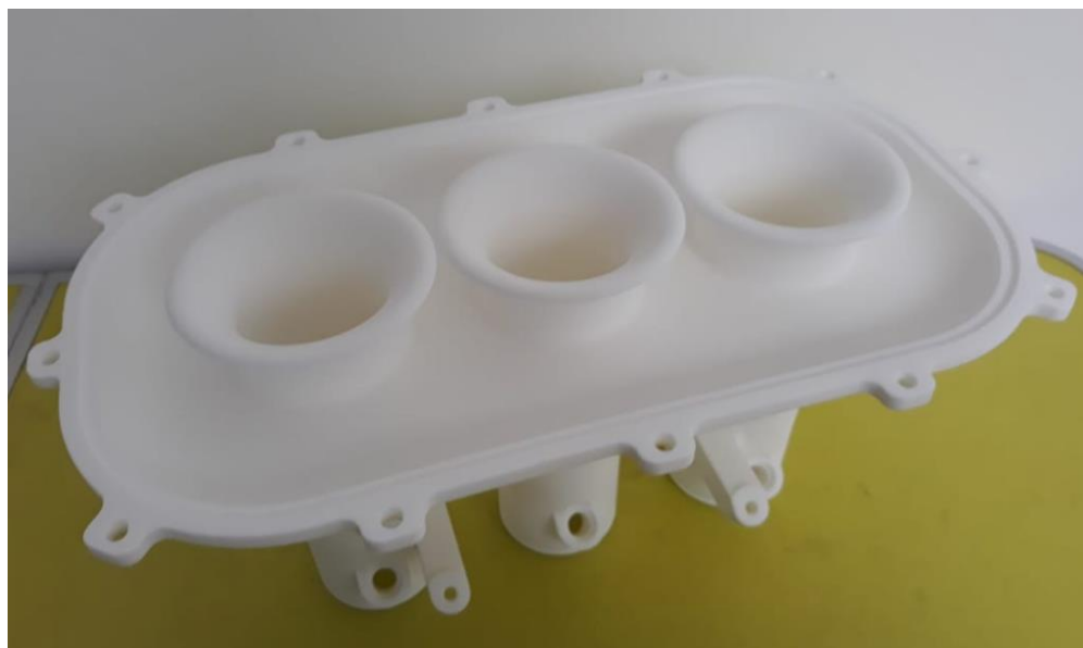
Obr. 64 – Spodní díl sání vytisknutý technologií SLS
