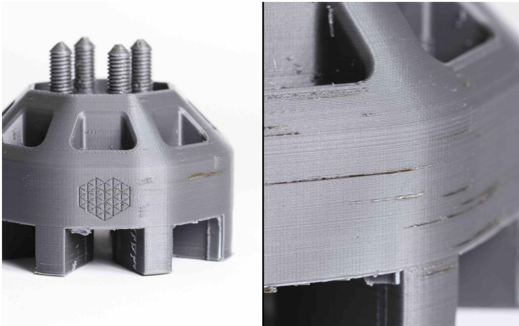
obr. 9 – Výrobek zhotovený metodou FDM – na detailu vpravo jsou dobře patrné jednotlivé tisknuté vrstvy [20]
