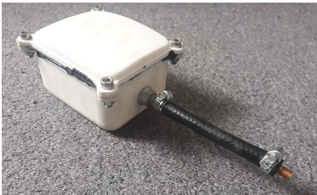
Obr. 16 – Vyrobený zkušební model utěsněný tmelem na motory
