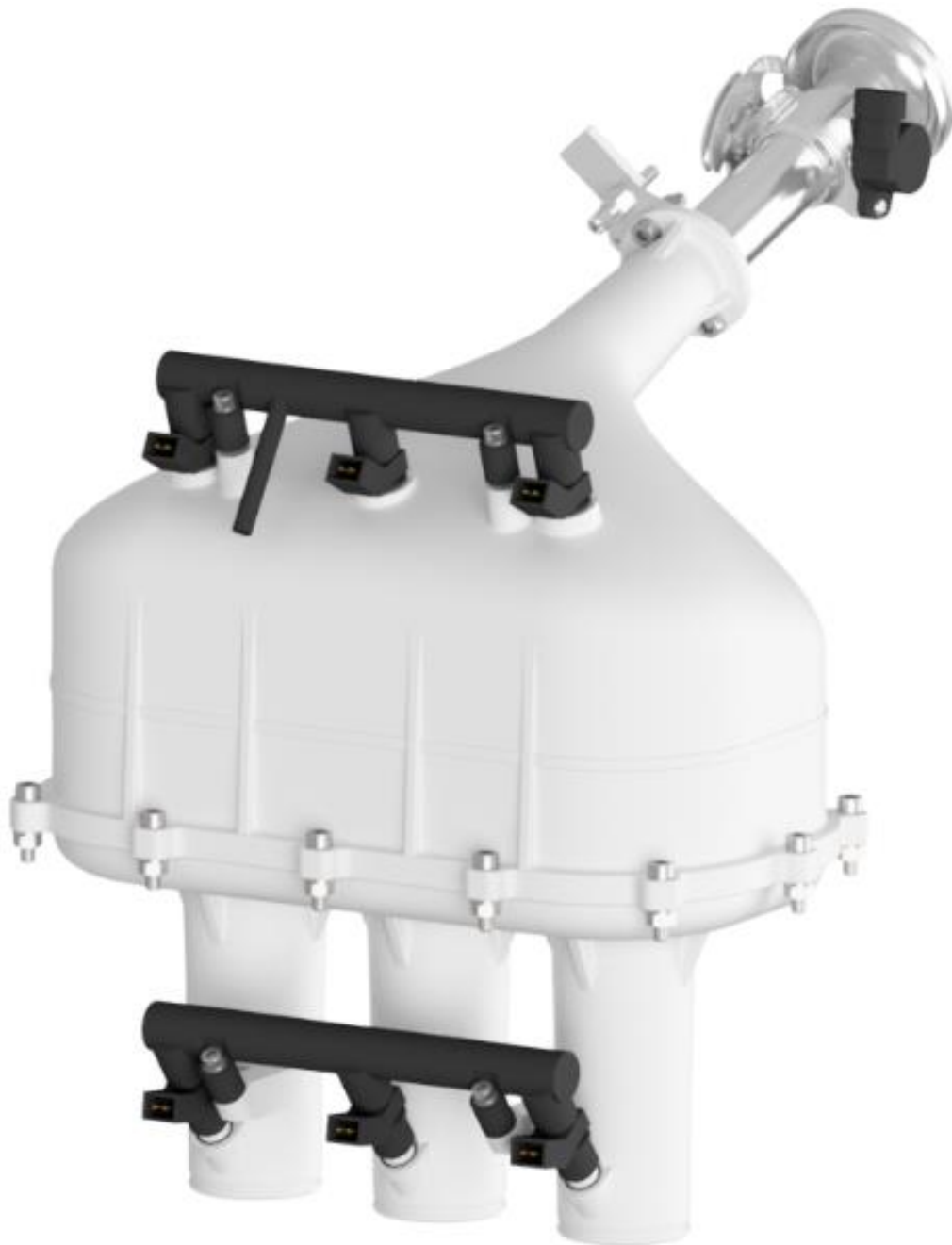
Obr. 46 – Vizualizace kompletního sacího systému, na obrázku jsou vidět obě sady vstřikovačů a škrťací klapka
