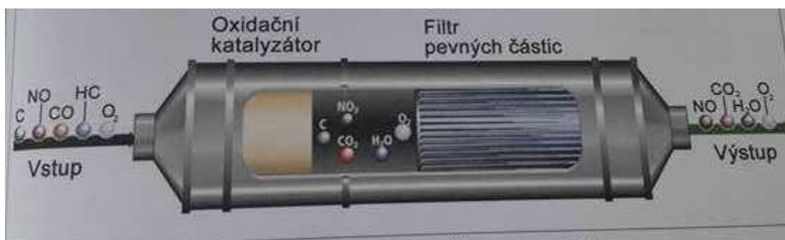
Obr. 4 Kombinace oxidačního katalyzátoru a filtru pevných částic. [27]
