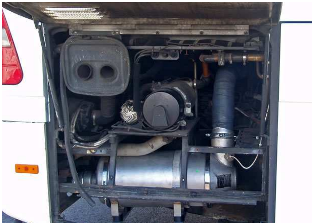
Obr. 7 Dodatečná montáž DPF u autobusu [3]
