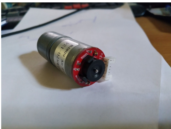
Obrázek 5.18: Enkodér s hallovými senzory na motoru
