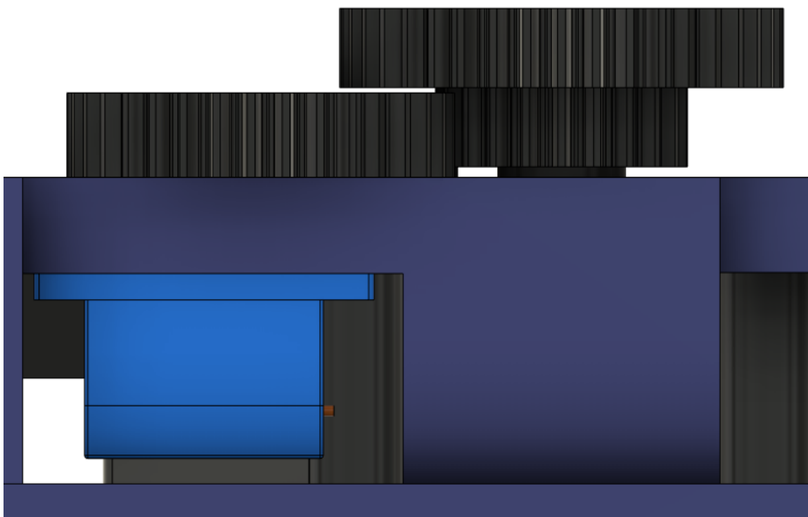
(b) Převodovka hřebenového řízení, pohled zepředu
