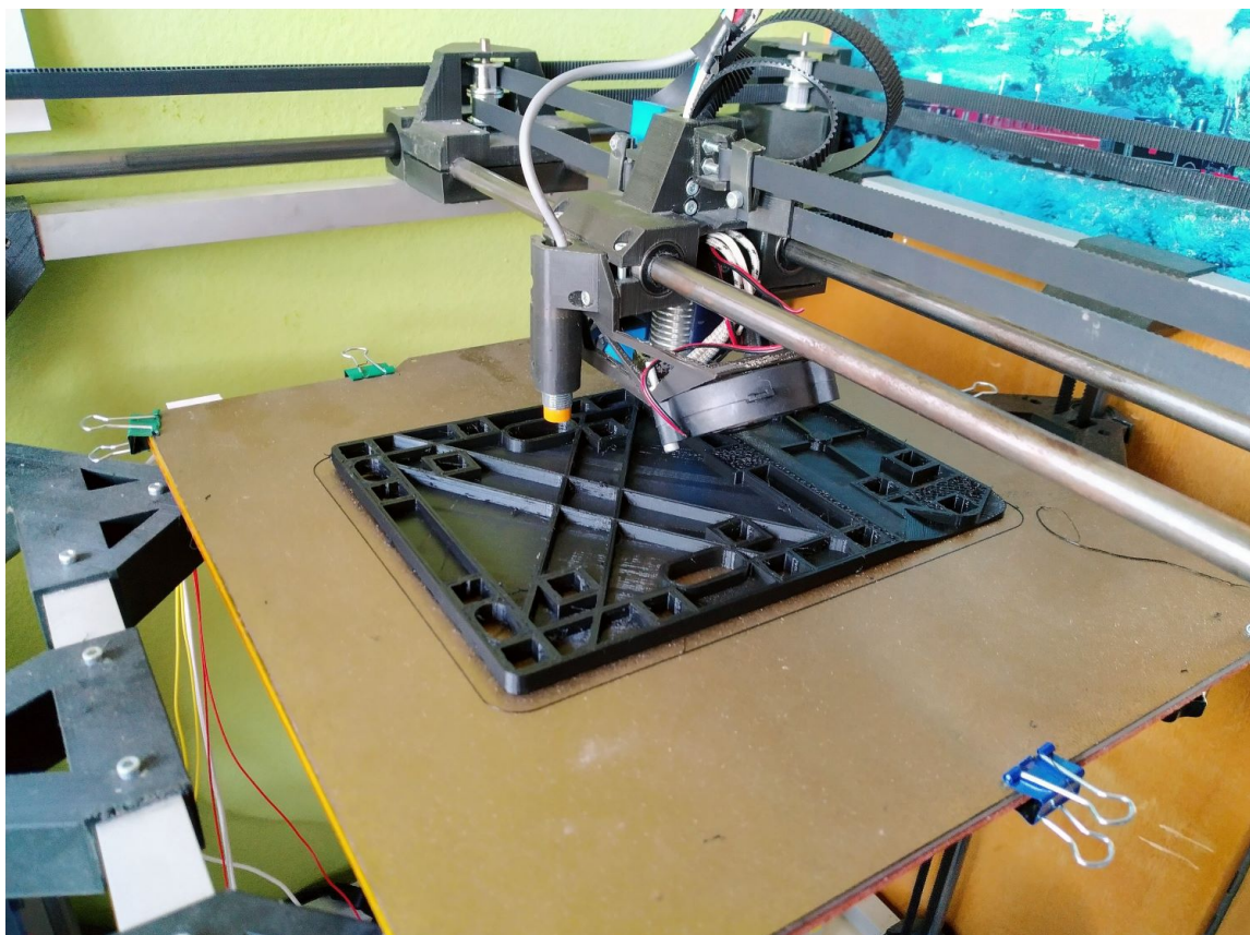
Obrázek 5.15: 3D tisk dílu podvozku
