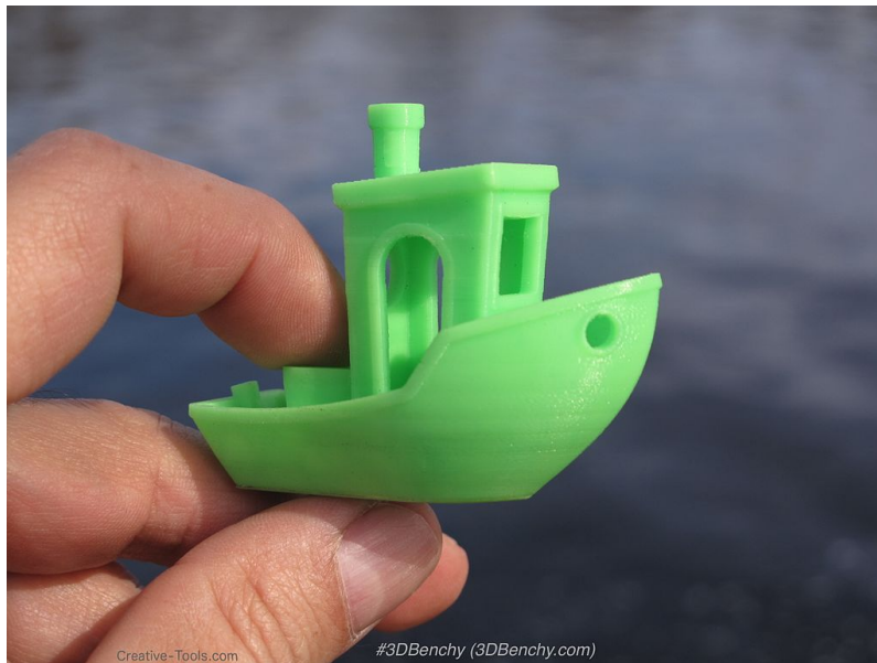
Obrázek 3.7: Předmět vyrobený metodou FFF, tzv. Benchy 7
