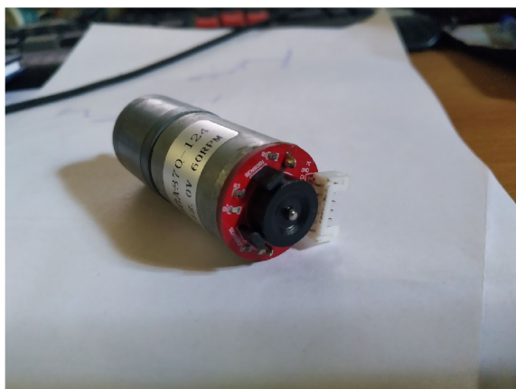
Obrázek 5.18: Enkodér s hallovými senzory na motoru
