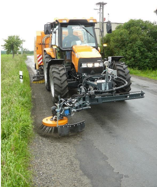
Obrázek 5: Agresivní kartáč AKP 800 (MTM TECH s.r.o., 2016).
