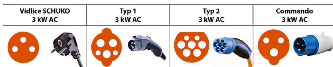
Obrázek 3.16: konektory pro pomalé nabíjení, (Elektroprumysl.cz, 2019)
